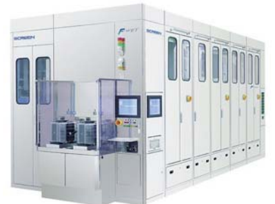
半導体洗浄装置「ウェットステーション FC-3100」
